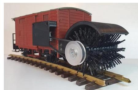
Die gesamte Einheit ist starr mit dem LGB Wagen verbunden und die Walze wird über einen seitlichen Riemen angetrieben. Ein Riemenschutz ist zudem an der Seite des Wagens befestigt.
