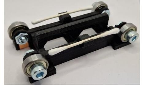
Dieser Rollenbock ist für einen Achsabstand von 78mm geeignet. Das Besondere ist die integrierte Radreinigung mit handelsüblichen Ohrenstäbchen. Durch die Vorspannung der Stäbchen, wird eine saubere Reinigung durchgeführt, ohne die Achse zu beschädigen.
