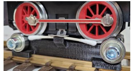
Für die Stromübertragung gibt es zwei Varianten, einmal über Kabel oder direkt vom stromleitenden Rollenbock.
