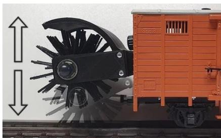
Die Walze wird nicht nur mittig angetrieben, sondern die gesamte Einheit lässt sich über eine Stellschraube in der Höhe verstellen. Dadurch bleibt zum einen die Breite des Wagens bestehen und ein seitlicher Anbau des Riemenantriebes entfällt.
