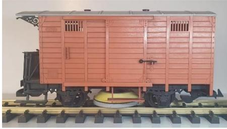
Ein rotierender Polierteller poliert bzw. schleift ihre Schienen sauber. Die eingebaute Steuerelektronik ist bis 10 Ampere abgesichert. Die Schleifpadhöhe, also der Abstand zwischen Schienenoberkante und Pad, wird durch Sie, mittels mitgelieferter Unterlegscheiben eingestellt.
