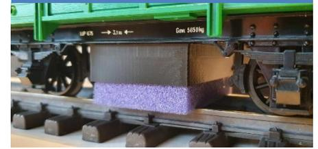
Passend zum Polierwagen gibt es diesen Reinigungseinsatz für den Niederbordwagen LGB 4010. Die bereits vorhandenen Schrauben des Wagens an der Unterscheite dienen gleichzeitig zur Befestigung des Reinigungseinsatzes.
