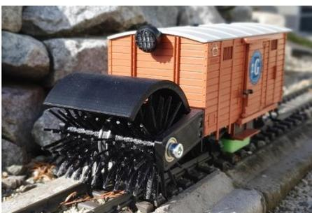
Die Bürsteneinheit ist starr mit dem Wagen verbunden. Die Walze wird mittig über ein Winkelgetriebe angetrieben. Die Borsten ragen dazu weit genug innerhalb des Schienenbettes hinein, um jeglichen Schmutz zu beseitigen.
