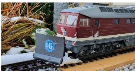
Es handelt sich hierbei um ein Schneeschild mit einer Gummilippe + Adapter. Der Adapter A1 oder A2 wird mit der Lok oder dem Wagen befestigt. Die vorhandene Kupplung wird dabei durch den Adapter ersetzt. Das Schneeschild wird an dem Adapter geschraubt und kann zusätzlich individuell eingestellt werden.
