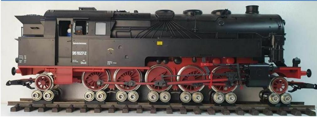
Ich biete bei der MINI-Variante zwei Varianten an. Jede besitzt andere Eigenschaften. Durch den Aufbau und der Anordnung der Kugellager, können Züge mit großen sowie mit kleinen Achsen problemlos auf dem Rollenbock aufgesetzt werden.
