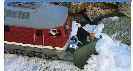
Der Schneepflug wird mittels eines Adapters an die Lok geschraubt. Die vorhandene Kupplung wird dabei ersetzt. Art.Nr. 12203
